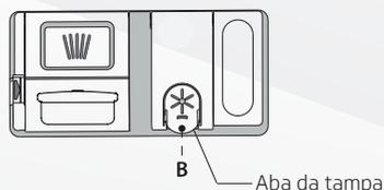
2. Despeje o líquido secante (máx. 110 ml), certificando-se de que não transborde do dosador. Se isso acontecer, limpe o derramamento imediatamente com um pano seco. O led indicador no painel ficará escuro e a luz do painel **Abastecer líquido secante** apagará.
