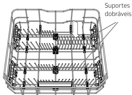
**ATENÇÃO:** O cesto inferior possui suportes dobráveis que podem ser utilizados na posição vertical para acomodar os pratos ou na posição horizontal (inferior) para colocar facilmente panelas e saladeiras.
