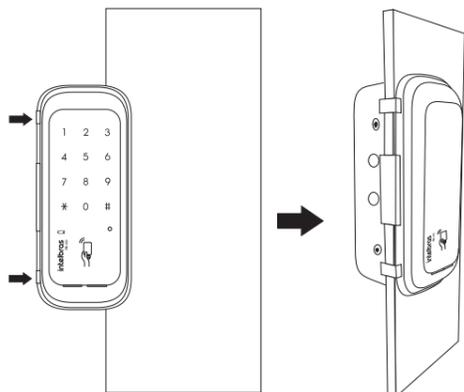
3. Feche a porta e gire a manopla para projetar a lingueta da fechadura. Utilize a falsa-testa como gabarito e verifique a posição correta para o alinhamento entre fechadura e a falsa-testa. Utilize um lápis/caneta e marque furos da falsa-testa na forra. Utilize uma broca de 14 mm para abrir os 3 furos centrais;
