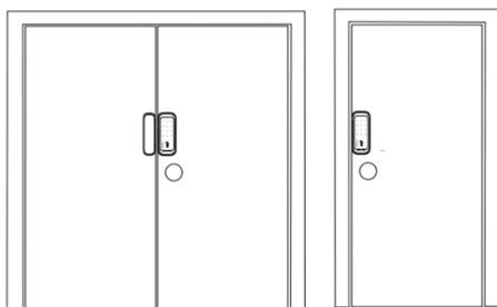
**Dica:** o teclado presente na parte externa se adapta automaticamente para o lado direito/esquerdo. Caso o teclado não ajuste automaticamente, pressione a tecla de reset conforme o tópico 6.1 do manual do usuário.
