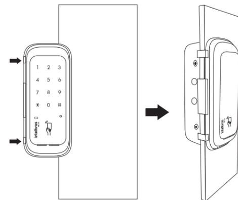
3. Feche a porta e gire a manopla para projetar a lingueta da fechadura. Pegue o batente e verifique a altura necessária para que haja o alinhamento do batente com a fechadura. Note que o batente possui 2 lados distintos – 1 de cor preta e 1 de cor prata. O batente deve ser posicionado de forma a combinar com a fechadura (preto com preto, prata com prata);
