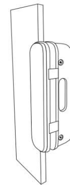
4. Posicione o batente na folha fixa de sua porta de vidro conforme a marcação realizada no item 3. Pressione o batente até que todo o corpo do batente esteja em contato com o vidro;
