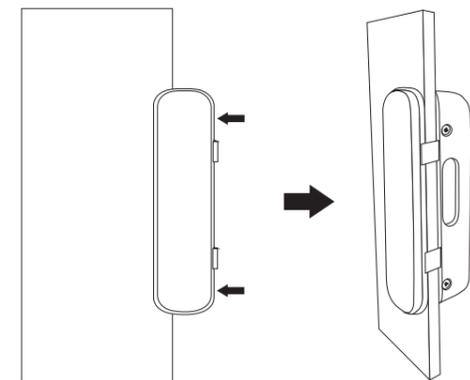
5. Feche a porta e gire a manopla para verificar se a fechadura e o batente estão alinhados. Faça alguns ajustes se for necessário;
