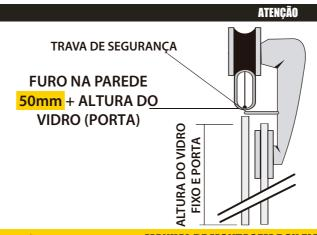
**PORTA** Máx. 700mm - 30 Kg **VIDRO** Temperado 8mm VÃO Máx. 2500mm **ALTURA**
