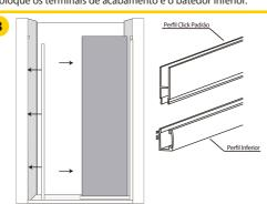
• Corte o perfil click padrão com a medida do vidro fixo e encaixe sobre o perfil guia. Depois, corte os perfis laterais, parafuse e vede
