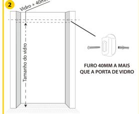
Parafuse o fixador na parede 40mm major que a altura do vidro da porta.
