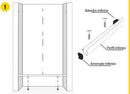
· Confira as medidas dos vidros, do vão e nível do chão. • Corte o Perfil Inferior, 3mm menor que a medida do vão, faça 3 furos para fixação e 3 furos para escoamento de água, parafuse e vede com silicone no local.
