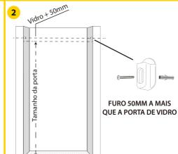
• Parafuse o fixador na parede **50mm** maior que a altura do vidro da porta.
