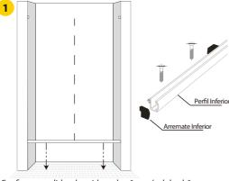
· Corte o Perfil Inferior, 3mm menor que a medida do vão, faça 3 furos para fixação e 3 furos para escoamento de água, parafuse e vede com silicone no local
