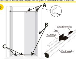
B) • Coloque a fita de vedação no vidro fixo C) • Encaixe a Guia, o Perfil Click e o Batedor no Perfil Inferior. Atenção: a 2º Roldana utiliza o pino flexível
