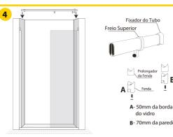
Corte o tubo superior 40mm menor que o vão. · Verifique o local onde ficará o freio e parafuse as fendas: A, a 50mm da borda do vidro e **B**, a 70mm da parede. Encaixe o trilho superior conforme a ilustração utilizando as capas prolongadoras das fendas. · Coloque o Freio e o fixador no tubo
